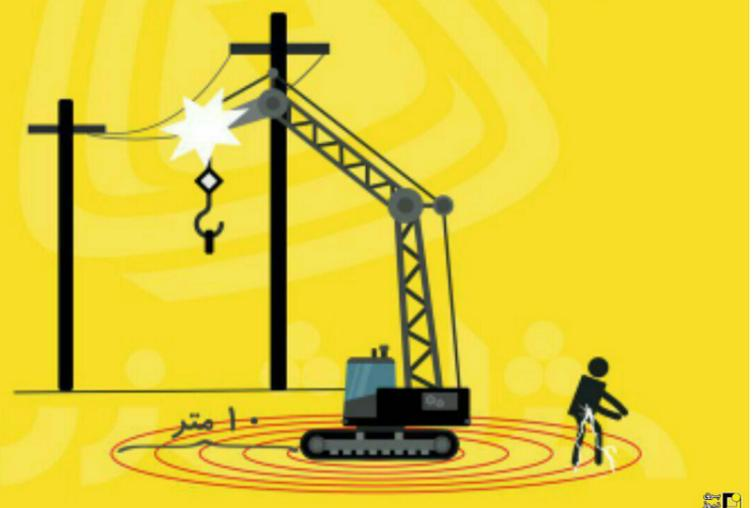
اگر شما خود را بر روی زمین برقدار بیابید و نیاز به حرکت برای دور شدن از آن را داشته باشید، می توانید با برداشتن گام های کوتاه از ایمن بودن خود در برابر شوک الکتریکی یا برق گرفتگی حاصل از ولتاژ گام اطمینان حاصل
